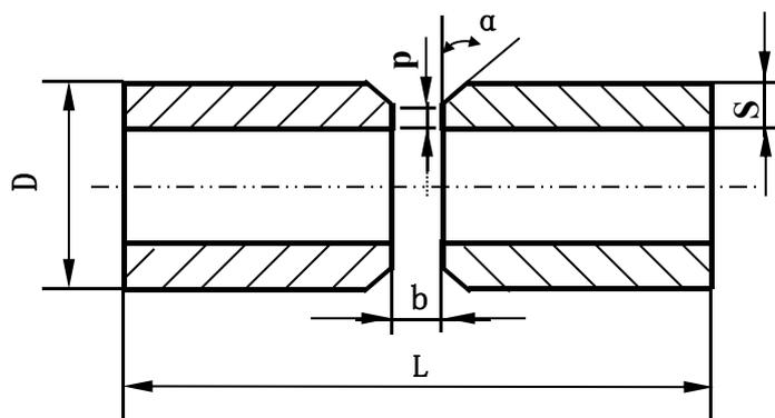
(3) 不锈钢管对接水平固定 5G 加障碍 (GTAW)
