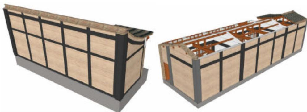
图 5.2.4 外加配筋砂浆带修缮加固示意图
