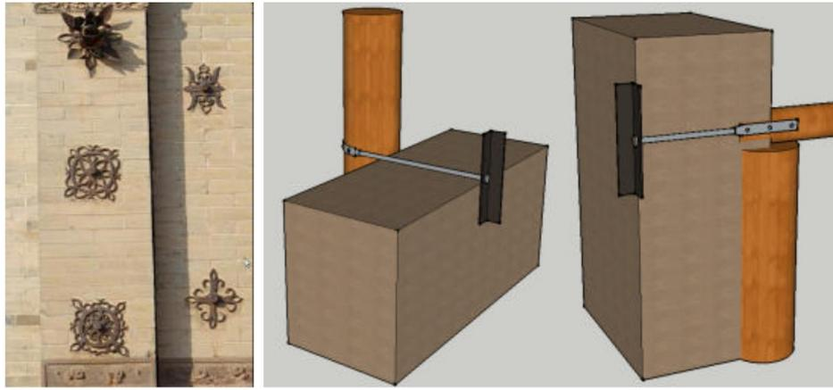
图 6.4.3-1 墙揽加固示意图
